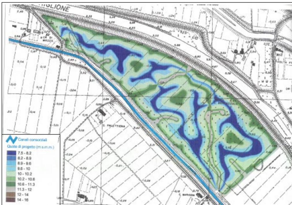
Fig.23 - Esempio di struttura di casse di espansione fluviale
