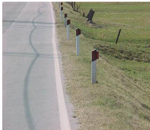
Fig.10 - Esempio di dissuasori ottici ai lati di una strada - (da [www.provincia.verbania.it](http://www.provincia.verbania.it))
