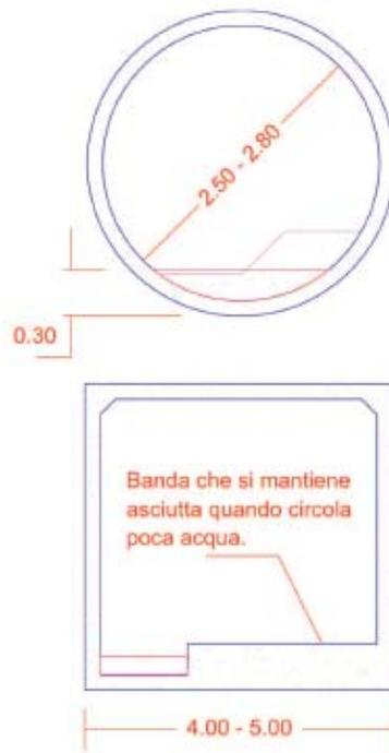
Fig. 8 - Adattamento di tombini di drenaggio e scatolari idraulici per il passaggio della fauna (tratto da Rivella – UTET Scienze Tecniche) – (da [www.arpa.piemonte.it](http://www.arpa.piemonte.it))
