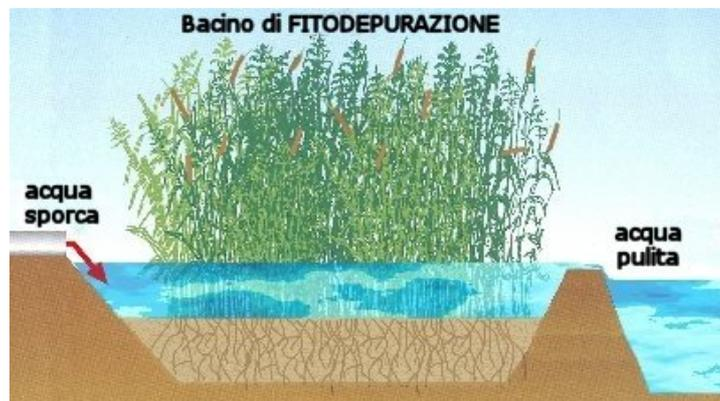
Fig.19 – Esempio di impianto di fitodepurazione
